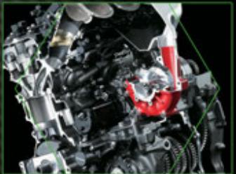
Menggunakan mesin supercharged yang didesain sendiri oleh Kawasaki. Teknologi Supercharged membantu mesin untuk mengeluarkan tenaga besar dengan dimensi yang kompak.
